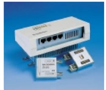
该installation交换机本身采用存储转发的交换程序。切换矩阵的设计适合最大5 x 200Mbit/s 的容量。此外，该交换机具有智能的、按照IEEE 802.3x 的流量控制。
